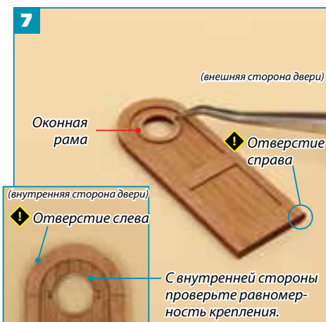
7 С внешней стороны двери при помощи клея для дерева прикрепите раму круглого окна. Переверните дверь и убедитесь, что рама встала ровно.
