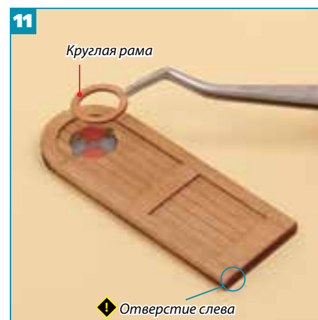
11 К внутренней стороне двери при помощи клея для дерева прикрепите вторую круглую раму.
